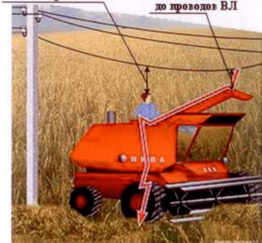
Расстояние от машины и механизмов до проводов ВЛ
